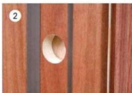
Percer dans l'axe marqué avec une mèche à bois plate de 25 mm
